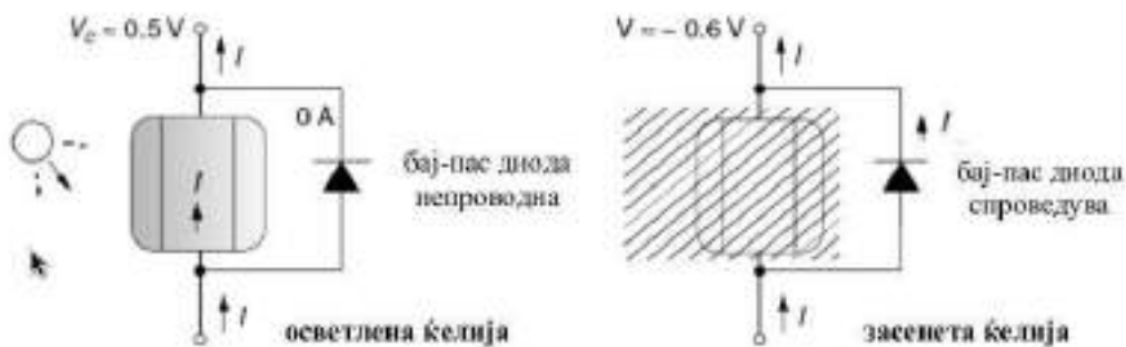
Слика Приклучување на бај-пас диода заради намалување на ефектот на сенка
